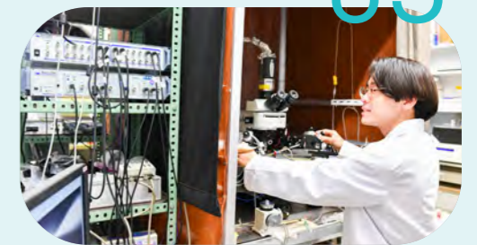
2つの神経細胞のシナプス接続などの特性を検証できる ダブル・パッチクランプ記録法電気生理学実験装置
