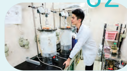
01 02 廃棄物・廃水を対象に 連続的なメタン発酵を検証する実験装置
