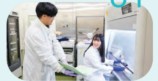
高リスク病原体を安全に扱うための P3レベル対応安全キャビネット
