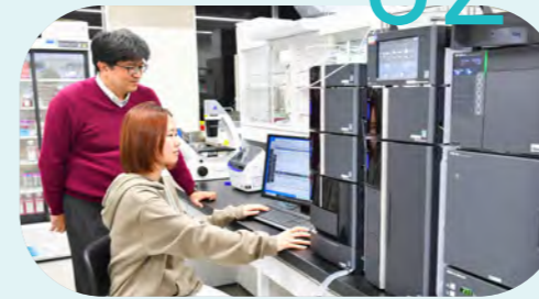
生体試料中の成分(分子)を分離・解析する 高速液体クロマトグラフィー装置
